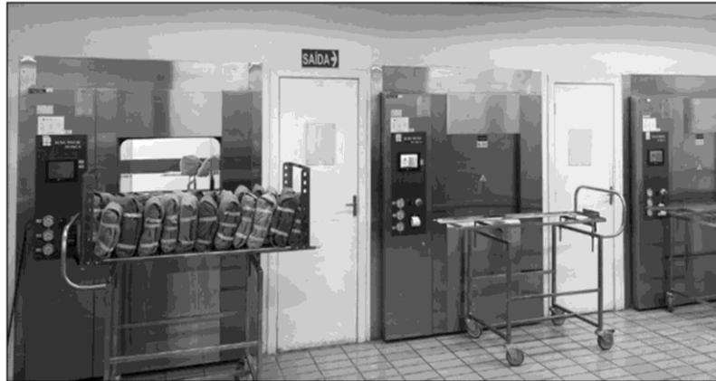
Figura 41 - Autoclaves de barreira no CME do HGPED.
